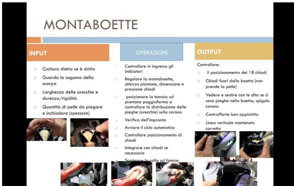
Fig. 8. Un esempio di repertorio attività del posto di lavoro "Montaboette", con il dettaglio degli indicatori per la diagnosi in input e il controllo dell'output del semilavorato
